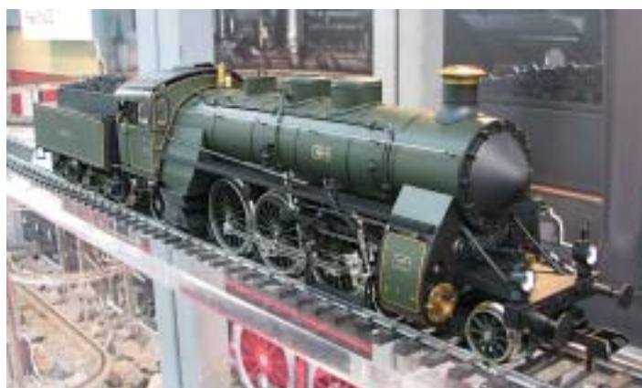
Märklinov model parne lokomotive vrste S 3/6 v merilu 1:32 (1) v barvah Kraljevih Bavarskih železnic (K.Bay.Sts.B.), ki za pogon uporablja živo paro, upravlja pa se z daljinskim vodenjem.
